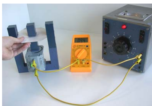
Abb. 9: Modellversuch zum Kurzschlussring-Sensor
