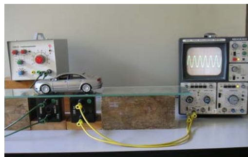
Abb. 5: Modell eines einfachen Fahrzeugdetektors
