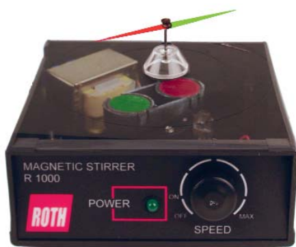
Abb. 3: Magnetrührer als „Hufeisenmagnet ersatz“ mit Blick ins „Innere“
