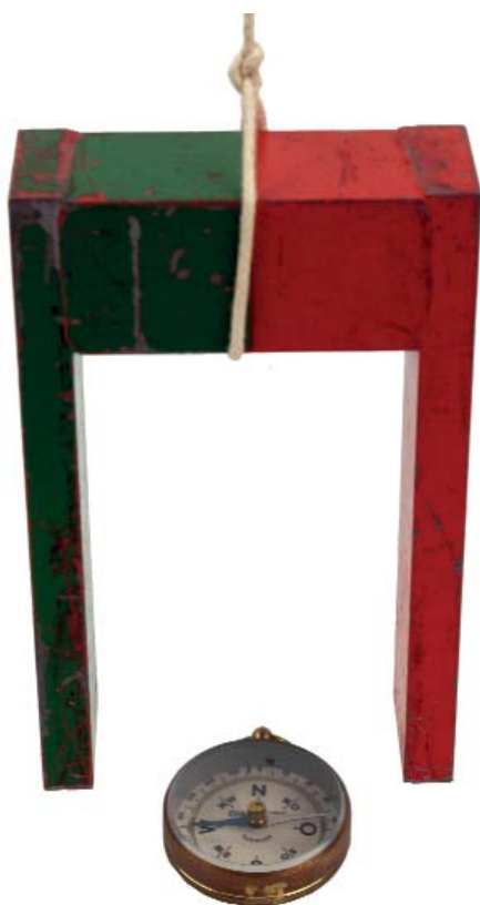
Abb. 2: Drehbar aufgehängter Hufeisenmagnet bewegt Magnetnadel
