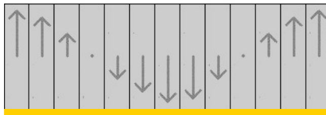
Abb. 24: Ein Streifenbild eines Geschwindigkeitsvektors ergibt ein t-v-Diagramm
