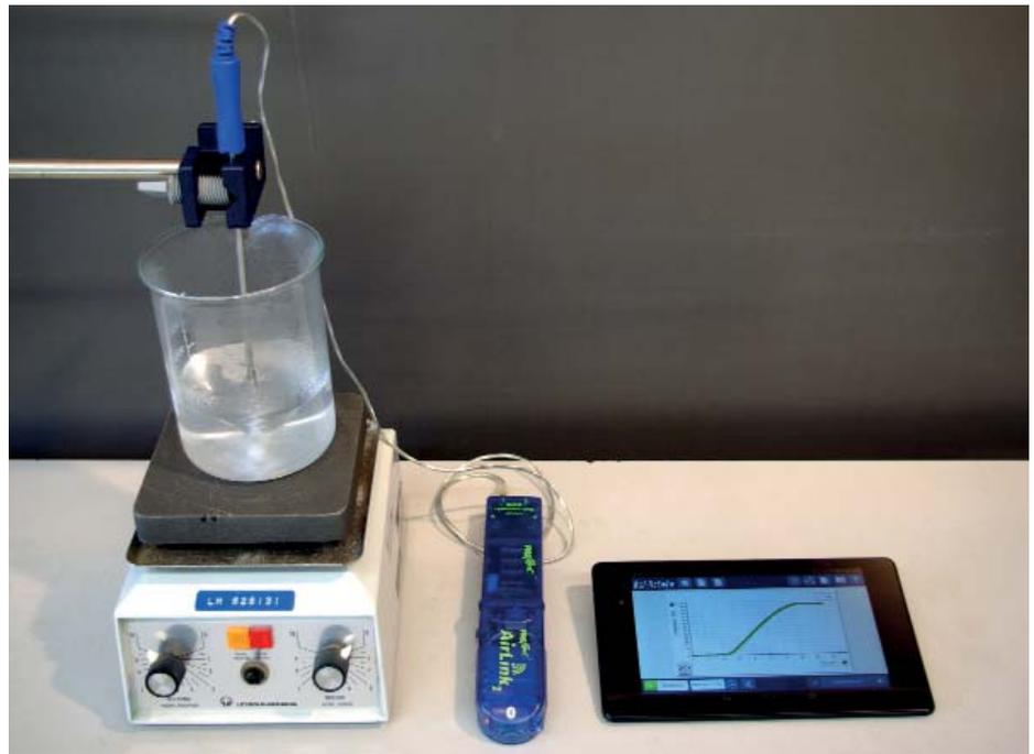
Abb. 1: Heizmagnetrührer, Temperatursensor und Air-Link 2 von Pasco sowie Tablet
