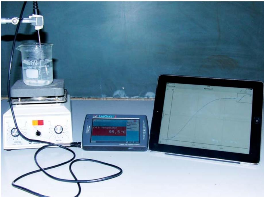
Abb. 3: Heizmagnetrührer, Temperatursensor, LabQuest 2 von Vernier sowie iPad
