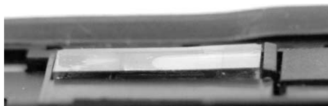
Abb. 5: Detailaufnahme eines Silikonkissens mit Abstandshalter rechts
