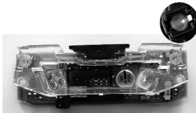
Abb. 4: Prismensystem des Regensensors mit Linsen zur Strahlaufweitung (links), Linse zur Fokussierung auf den Sensor (rechts) und dem Filter (oben)
