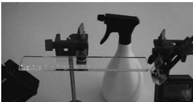
Abb. 22: Modell mit Glasplatte und Sensor (LDR)
