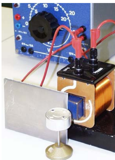
Abb. 16: Ein einfacheres Modell eines Spaltpolmotors
