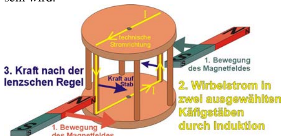
Abb. 4: Ströme in zwei Stäben eines Käfigläufers
