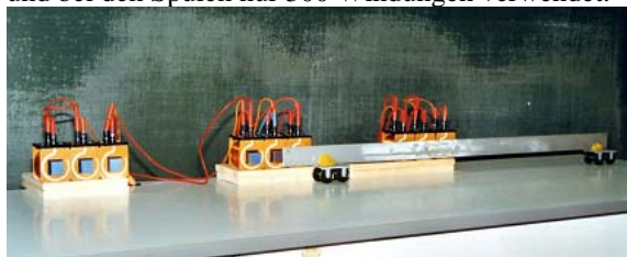
Abb. 12: Linearer Motor einer anderen Schülergruppe im Unterrichtsprojekt
