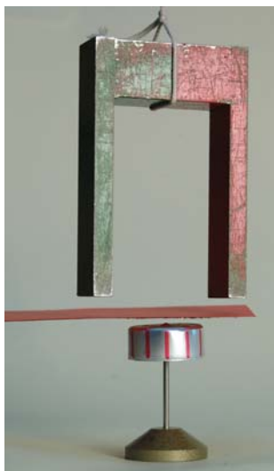
Abb. 2: An Schnur rotierender Hufeisenmagnet über Teelichtdöschen (Postkarte zur Windabschottung)
