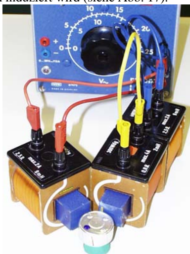
Abb. 17: Ein weiteres Modell eines Spaltpolmotors
