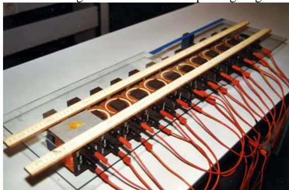
Abb. 11: Linearer Motor einer Schülergruppe in einem Unterrichtsprojekt
