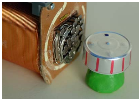
Abb. 13: Modell eines Spaltpolmotors
