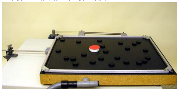
Abb. 2: Großer Luftkissentisch mit rotierendem Rahmen (hellgrau)
