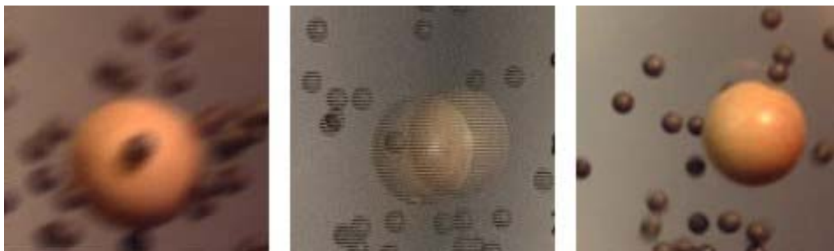
Abb. 1: Videoaufnahmen einer Holzkugel in der „Rüttelkammer: a) zu lange Belichtungszeit b) keine Vollbilder c) gut auswertbares Bild
