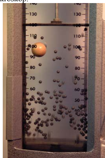
Abb. 10: Rüttelkammer mit Holzkugel
