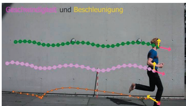
Abb. 10. Bahnkurve von Kopf (grün), Hüfte (rosa) und Fuß (orange) sowie Geschwindigkeitsvektor (violett) und Beschleunigungsvektor (gelb) an allen drei Körperpunkten
