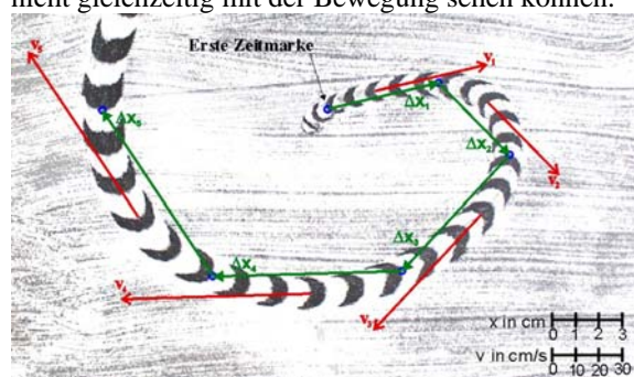
Abb. 8: Auswertung der Fingerbewegung im Schwefelstaub mit Ortsänderungsvektoren und Geschwindigkeitsvektoren
