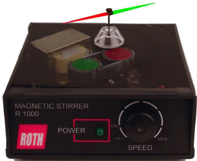
Abb. 3: Magnetrührer als „Hufeisenmagnetersatz“ mit Blick ins „Innere“
