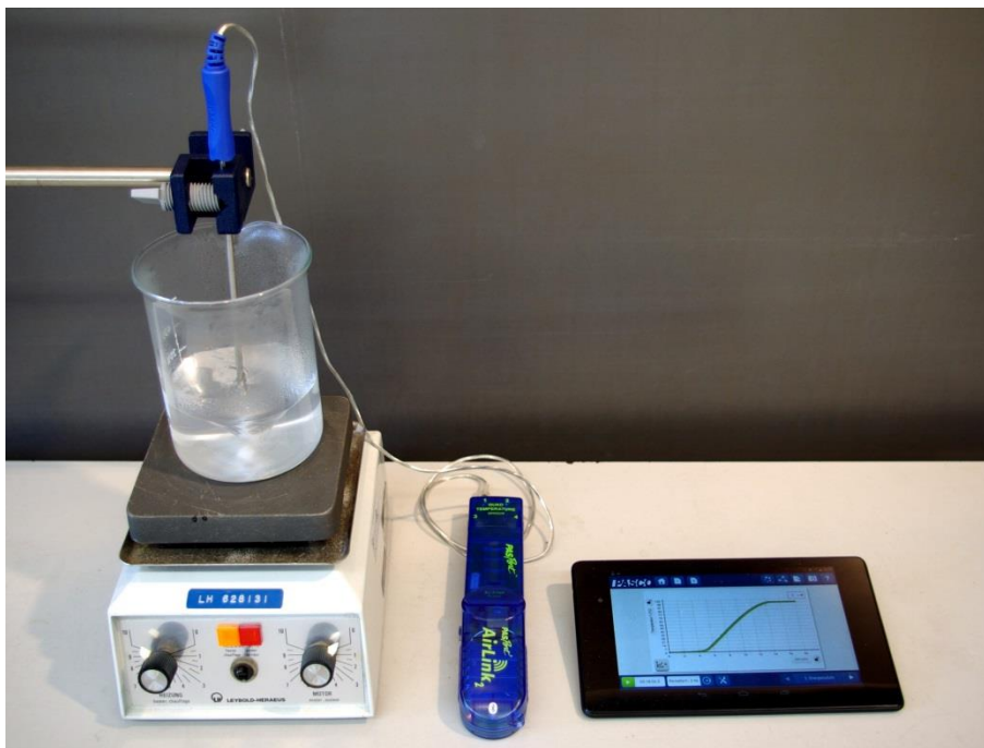
Abb. 1: Heizmagnetrührer, Temperatursensor und Air-Link 2 von Pasco sowie Tablet
