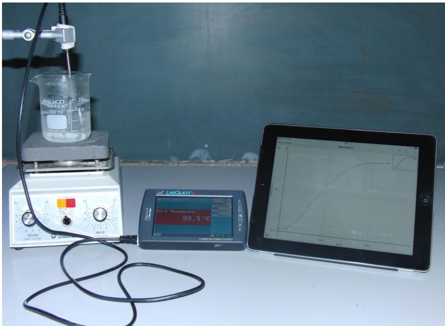
Abb. 3: Heizmagnetrührer, Temperatursensor, LabQuest 2 von Vernier sowie iPad
