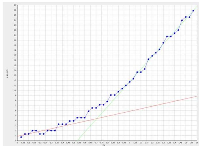
Abb. 4:  $v(t)$ -Diagramm einer kleinen, im Mineralwasser aufsteigenden Gasblase (gemessen mit der Videoanalyse)
