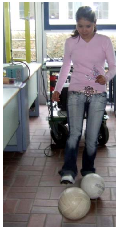
Abb. 9: Versuche mit einem normalen und einem mit Sand gefüllten Volleyball, um die Bedeutung der Masse deutlich zu machen: Je größer die Masse des Balles, umso schwerer ist er zu beschleunigen
