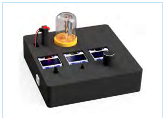
Abb. 1. 3D-gedrucktes Experiment zum Fotoeffekt: Lichtquelle, Fotozelle (mittig mit gelbem Fuß), drei Displays und Bedienelemente
