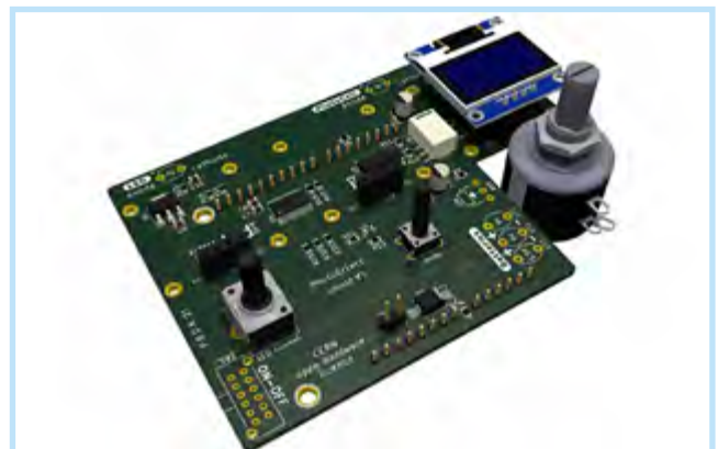
Abb. 3. Das Fotoeffekt-Shield zum Aufstecken auf einen Arduino Uno
