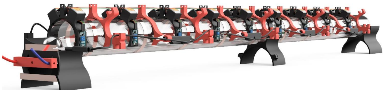
3 | Das vollständige Beschleunigermodell mit Halterung für die Hochspannungs-Experimentierkabel (rot) und Lichtschranken (schwarz)
