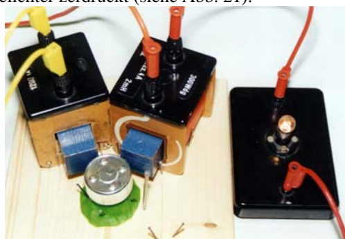
Abb. 21: Modell eines Wechselstromzählers, von Schülern gebaut
