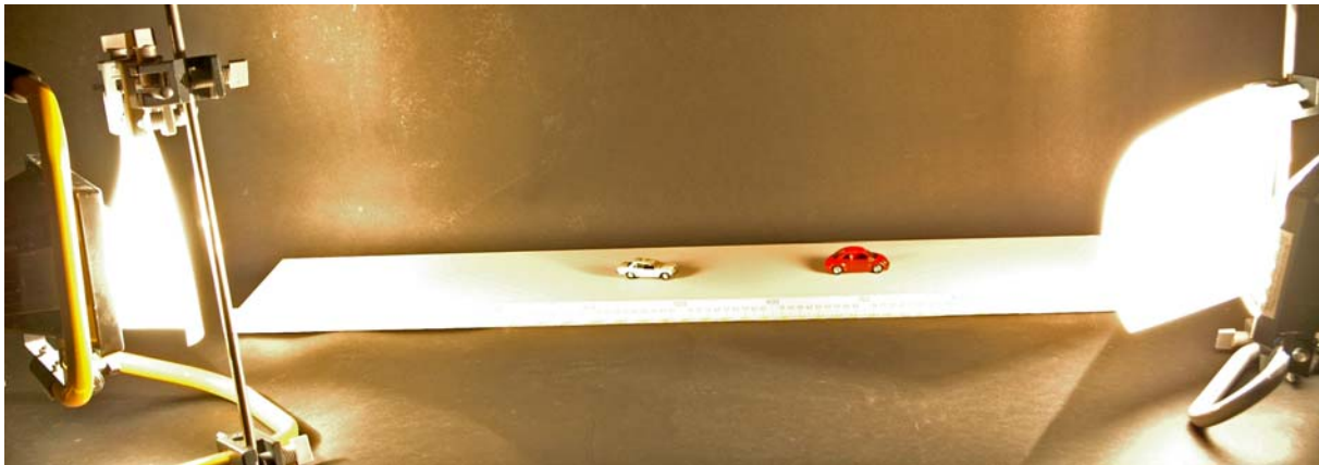
Abb. 12: Beleuchtung eines Stoßversuches mit zwei selbstgebauten Scheinwerfern mit diffussem Licht
