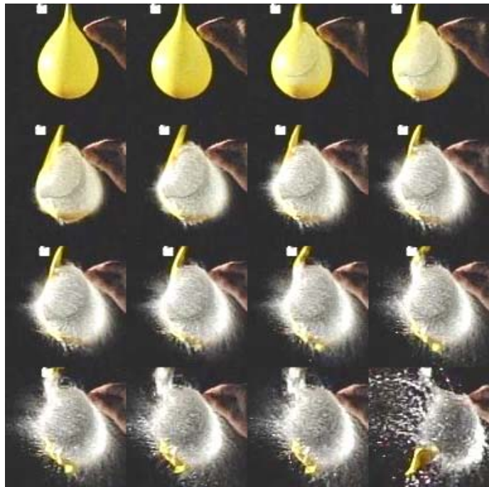
Abb. 1: Zeitlicher Verlauf eines platzenden Luftballons aus einem Video (zwischen den einzelnen Bildern vergehen jeweils 1/1200 s = 0,8 ms; nur zwischen vorletztem und letztem Bild liegen 1/40 s = 25 ms vergangen).
