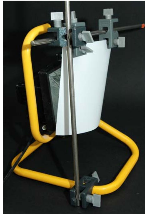
Abb. 13: Baustrahler mit vorgehängter Diffusorfolie
