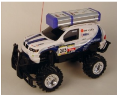
Abb. 14: Modellauto mit Beschleunigungssensor
