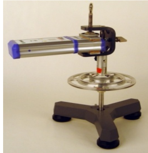
Abb. 9: Cobra4-Sensor drehbar gelagert
