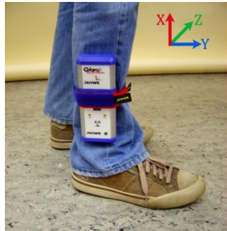
Abb. 20: Beschleunigungsmessung am Unterschenkel
