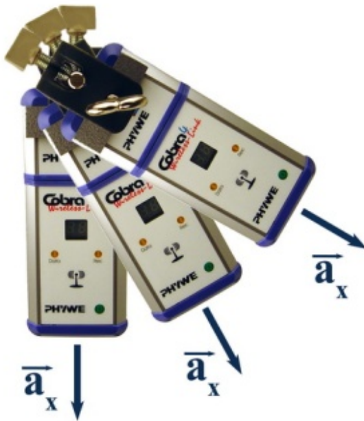
Abb. 10: Die x-Achse des Beschleunigungssensors zeigt immer in radiale Richtung
