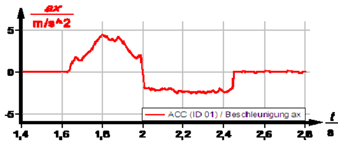
Abb. 1: Beschleunigung beim Anschieben ( t = 1,65 s bis t = 2,0 s) und Gleiten ( t = 2,0 s bis t = 2,45 s) des Beschleunigungssensors in Bewegungsrichtung
