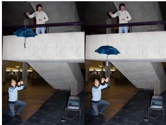
Abb. 6: Regenschirm als Fallschirm mit Cobra4-Sensor
