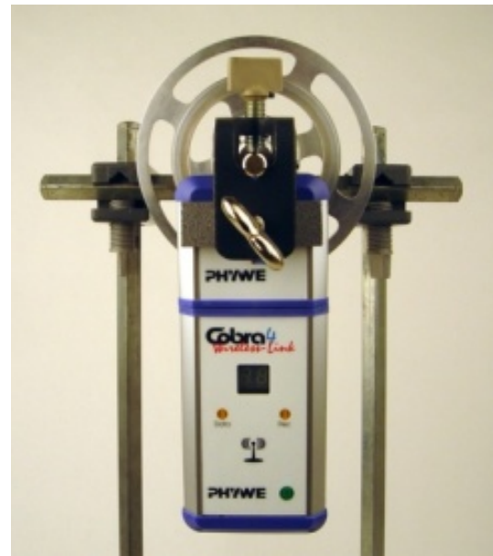
Abb. 16: Beschleunigungssensor als Stabpendel
