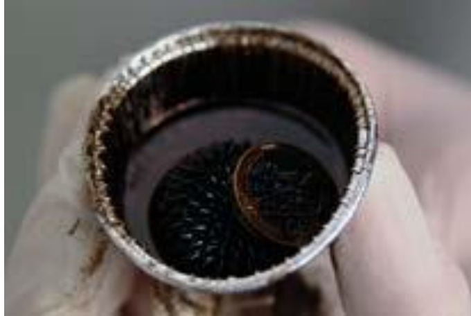
Abb. 8: Bei Anlegen eines externen Magnetfelds kommt die Münze wieder zum Vorschein.
