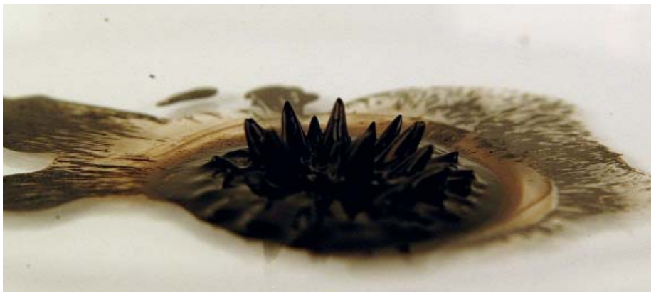
Abb. 3: Nach Zugabe der 25%-igen Tetramethylammonium-Hydroxid-Lösung erhält man das Ferrofluid, das in einem Magnetfeld die Rosensweig-Instabilitäten zeigt
