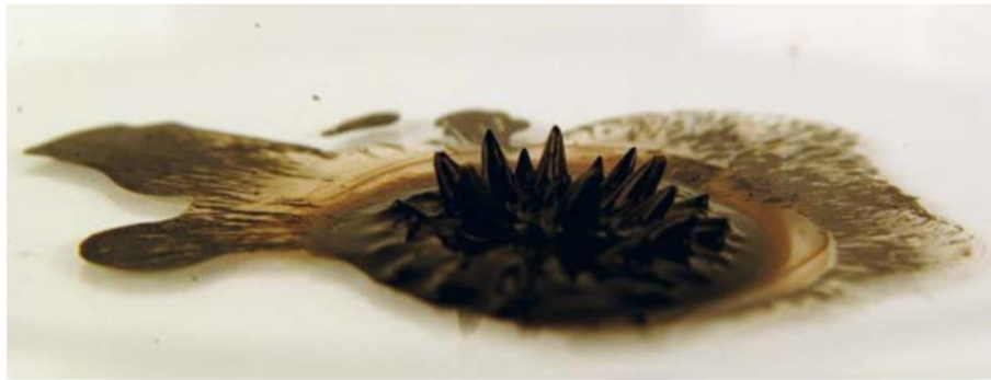
Abb. 3: Nach Zugabe der 25%-igen Tetramethylammonium-Hydroxid-Lösung erhält man das Ferrofluid, das in einem Magnetfeld die Rosensweig-Instabilitäten zeigt
