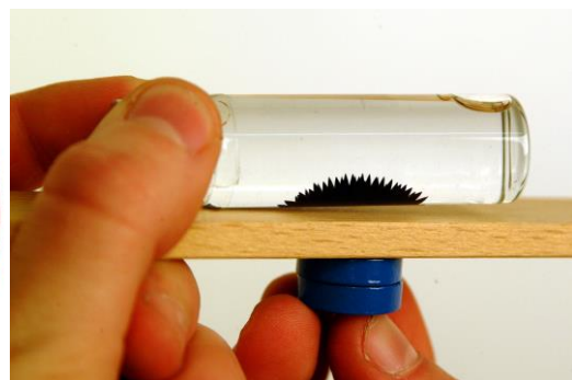
Abb. 4: Verlauf der B-Magnetfeldlinien in nicht-magnetischen Materialien (geringe Permeabilität) und dessen Visualisierung mit einem Ferrofluid
