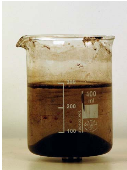
Abb. 2: Nach vollständiger Zugabe von Ammoniumhydroxid lässt man den Niederschlag absetzen. Die klare Flüssigkeit wird mehrmals abdekantiert.
