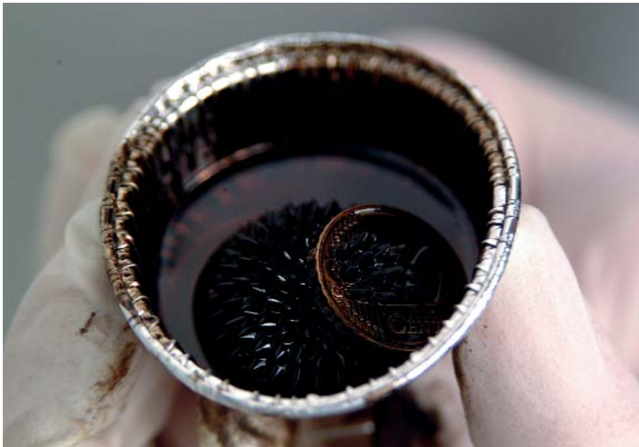
Abb. 8: Bei Anlegen eines externen Magnetfelds kommt die Münze wieder zum Vorschein.
