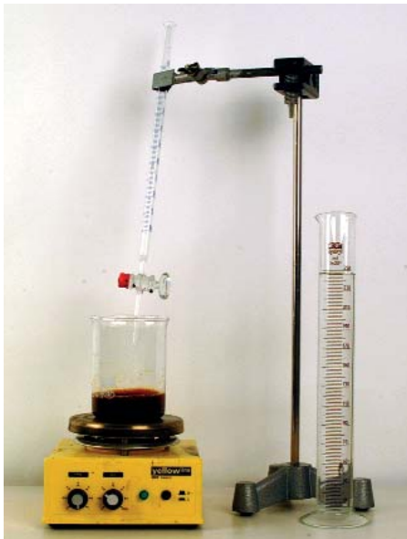
Abb. 1: Die tröpfchenweise Zugabe von verdünntem Ammoniumhydroxid führt zur Ausfällung von Magnetit.
