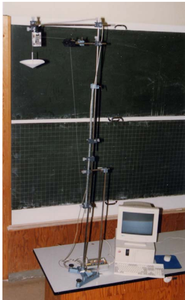
Abb. 2: Versuchsaufbau für die Bewegungsaufnahme mit einem Messwerterfassungssystem
