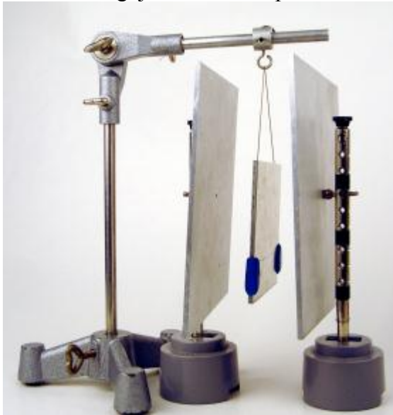
Abb. 9: Modellexperiment eines Differentialkondensators
