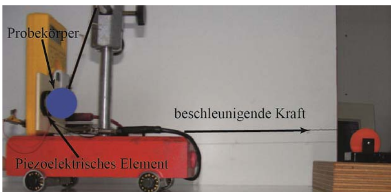
Abb. 18: Modell eines piezoelektrischen Beschleunigungssensors (nach [8])
