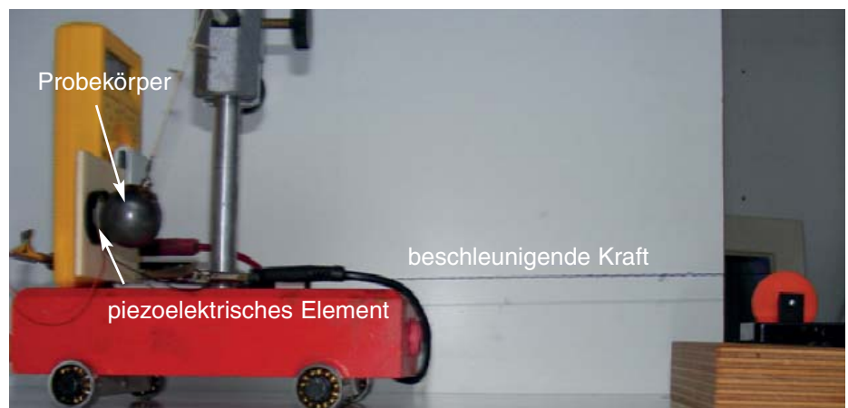
Abb. 18: Piezoelektrischen Beschleunigungssensor in der Messanordnung (nach [8])
