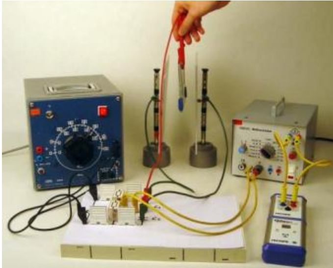
Abb. 12: Aufbau für Messungen am Modell eines Differentialkondensators
