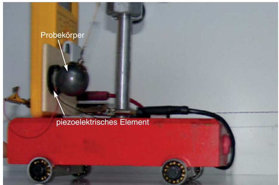
Abb. 17: Modell eines piezoelektrischen Beschleunigungssensors vergrößert (nach [8])
