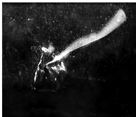
Abb. 6: Nebelspur von einem radioaktiven Mineral
