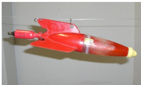
Abb. 13: Raketenmodell mit CO 2 -Patrone als Antrieb
