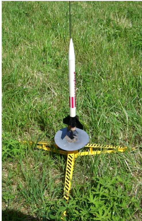
Abb. 22: Startbereite Modellrakete auf Startrampe mit Leitstab
