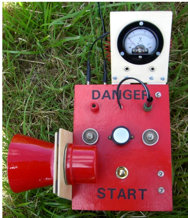
Abb. 23: Selbstgebautes Startgerät mit Lautsprecher für das Warnsignal (Design by Michael Kamprad)
